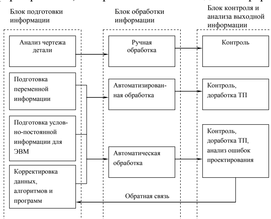
Рис. 2.2 Схема проектирования технологического процесса
